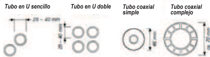
Figura 27. Secciones de diferentes tipos de intercambiadores verticales
