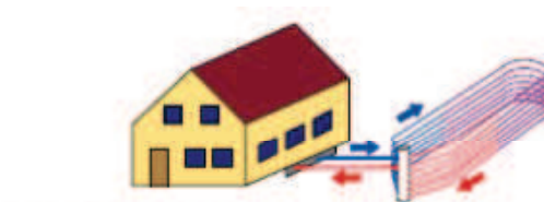
Colector en zanja
